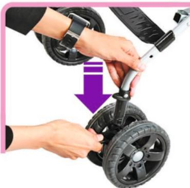
جهت ثابت و متحرک کردن چرخ های جلو از اهرم نشان داده شده در شکل مقابل استفاده نمایید.
