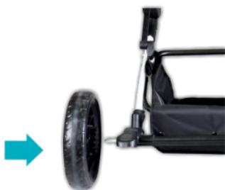
۵- پین چرخ را داخل توپی روی بدنه قرار داده و با فشار به سمت بالا جا بزنید(جهت اطمینان تست شود)
