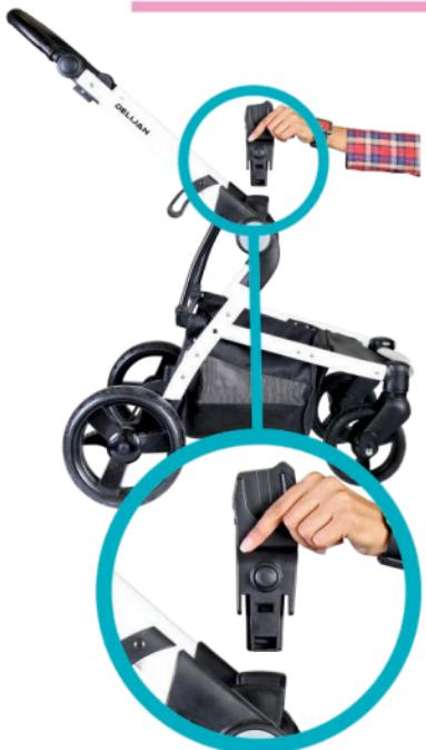
۷- جهت نصب کریر روی کالسکه قطعه مبدل را مانند شکل نصب نمایید و سپس کریر را در جهت دلخواه روی بدن کالسکه نصب نمایید. (در دو جهت قابل نصب است)
